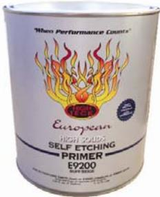
**E9200** es un imprimador autograbante de uretano 2K con alto contenido de sólidos que seca rápidamente. Es coloreable, anticorrosivo, fácil de lijar, tiene excelente capacidad de rellenado y se le puede aplicar una capa final. Se puede aplicar sobre metales desnudos, plásticos, fibra de vidrio, parachoques (sin un agente flexible) y recubrimiento E-coat sin lijar.
